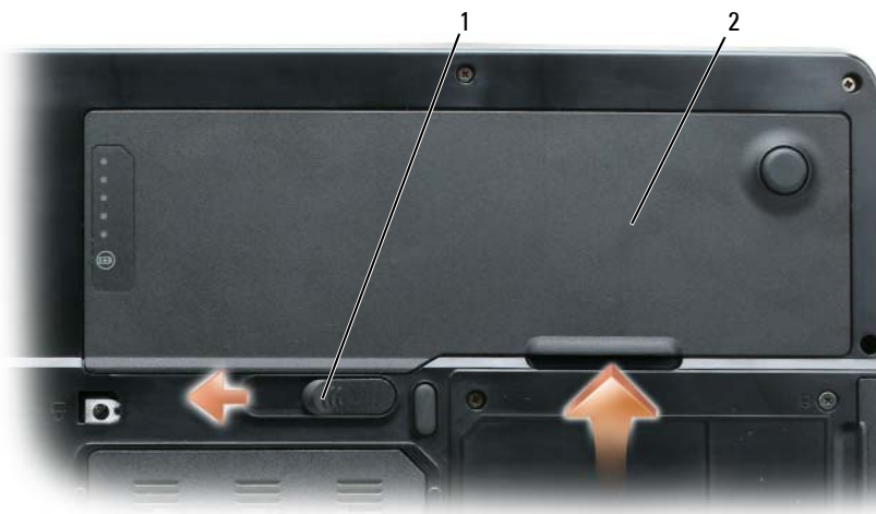
1 zatrzask zwalniający wnęki akumulatora 2 akumulator
