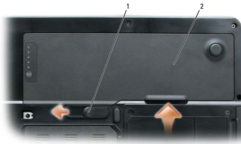
1 zatrzask zwalniający wnęki akumulatora 2 akumulator
